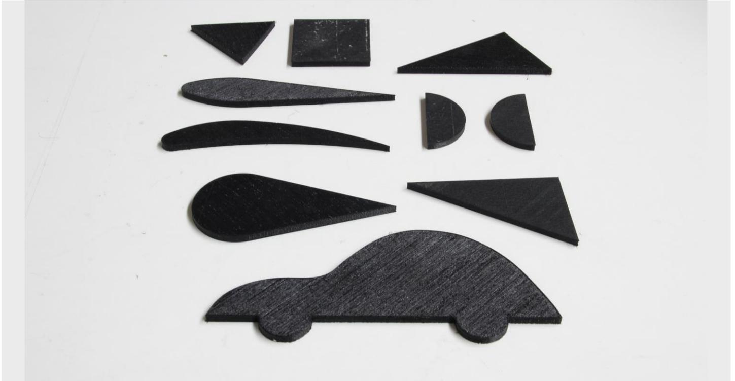
El equipo incluye diferentes modelos: perfil coche, perfil aerodinámico, círculo, rectángulo, cuadrado, etc.
